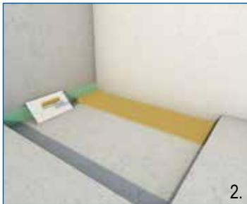
DE Vorbereitung des Untergrundes (gerade Fläche), Klebmermortel auf Untergrund auftragen
